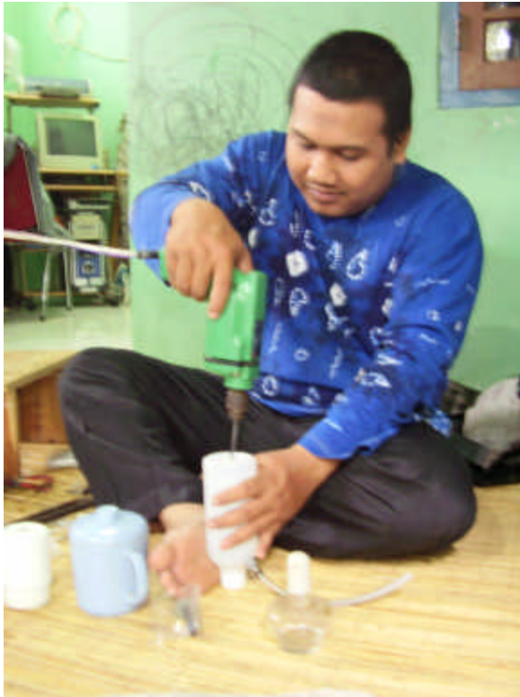
Dalam melubangi sebaiknya menggunakan bor agar sisi-sisi lubang terlihat lebih rapih
